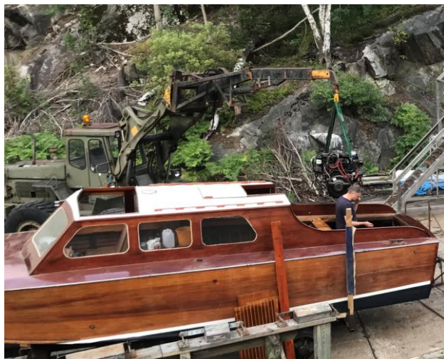
I slutet av juli lyftes Tritons motor på plats
