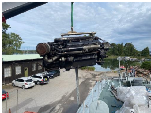
1,5 ton CRM-motor svävar ovanför T56
